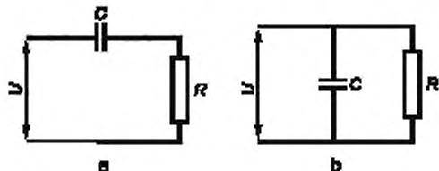
Рисунок M.3 — Эталонная активно-емкостная нагрузка:
