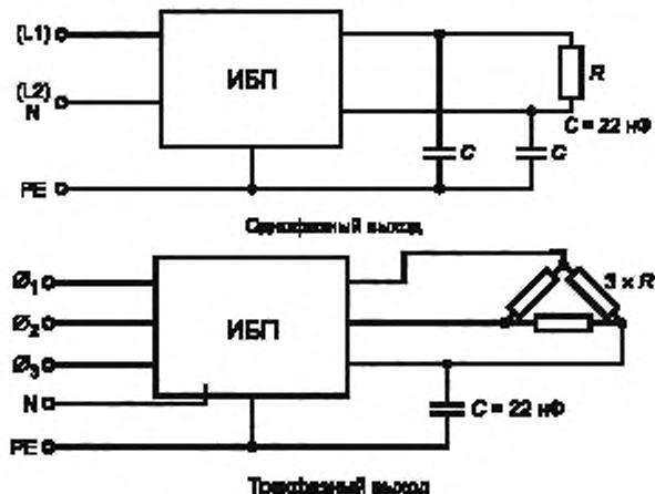
Рисунок L.1 — Схема подключения испытуемого ИБП
